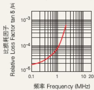
注：以上数据是根据标准样环  $\phi 25 \times \phi 15 \times 8$  获得的典型数据，有关产品的具体性能会在此基础上有所调整。
