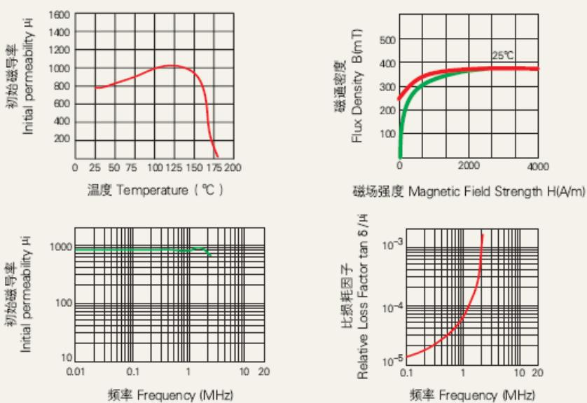
注：以上数据是根据标准样环  $\varnothing 25 \times \varnothing 15 \times 8$  获得的典型数据，有关产品的具体性能会在此基础上有所调整。
